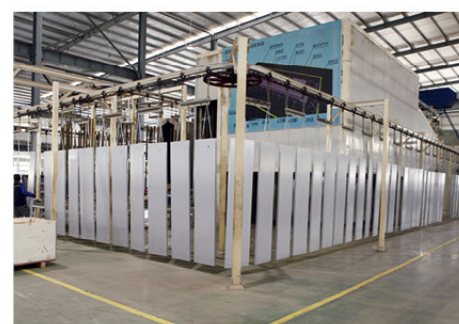
Автоматическая окрасочная линия Wagner, Германия.
