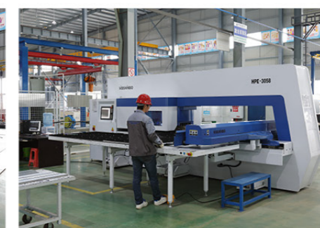
Японская транснациональная компания Nisshinbo Multi-Station Turret Punch Press
